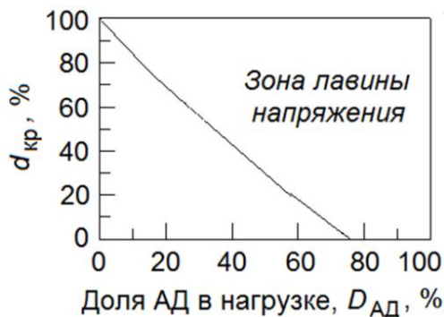
Рис. 3.3.3. Зависимость критического дефицита мощности от состава нагрузки в случаях, когда отключения ГУ на объекте РГ сопровождаются трехфазным КЗ длительностью 0,2 с. Здесь нагрузка в результате КЗ не уменьшается
