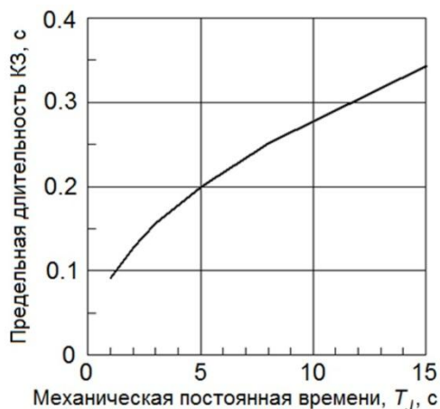
Рис. 2.1.6. Зависимость предельной по динамической устойчивости длительности трехфазного КЗ от значений T_J при средних параметрах генераторов
