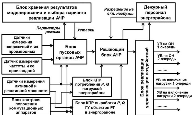
Рис. 5.8. Структурная схема устройства, реализующего усовершенствованный алгоритм АЧР
