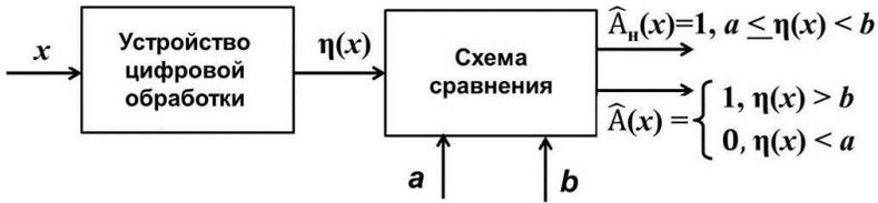
Рис. 2.27. Структурная схема устройства распознавания режимов
