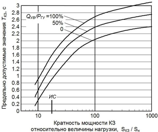
Рис. 4.10. Графики предельно допустимых длительностей трехфазного КЗ при разных величинах  $S_{КЗ}$ . ИС – исходная схема внешнего электроснабжения энергорайона
