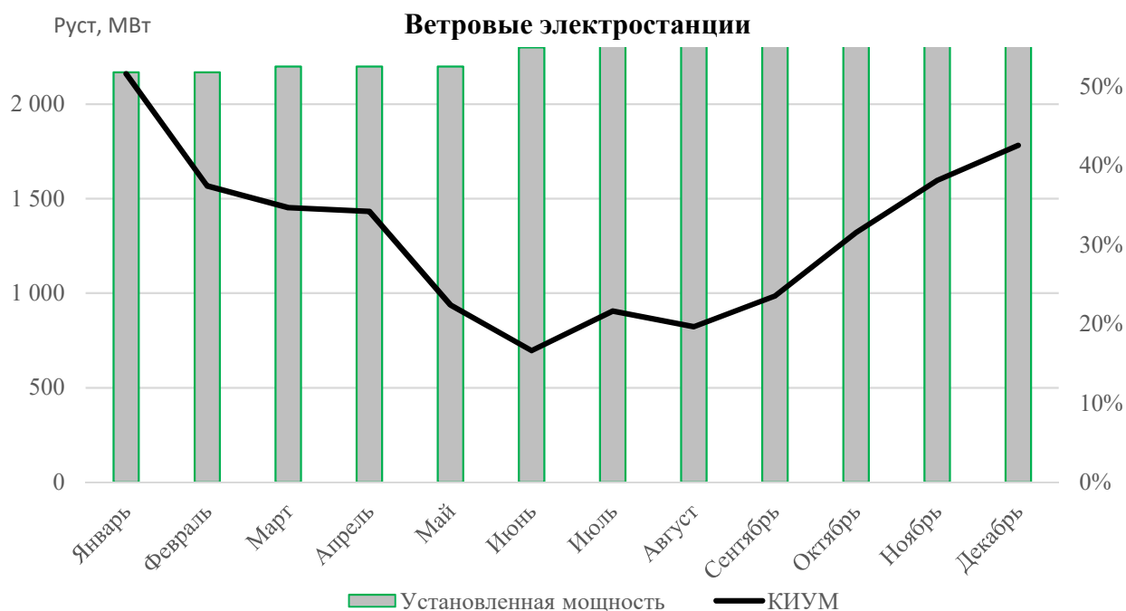
Рисунок XII.2 – КИУМ и установленная мощность ветровых электростанций в 2023 году
