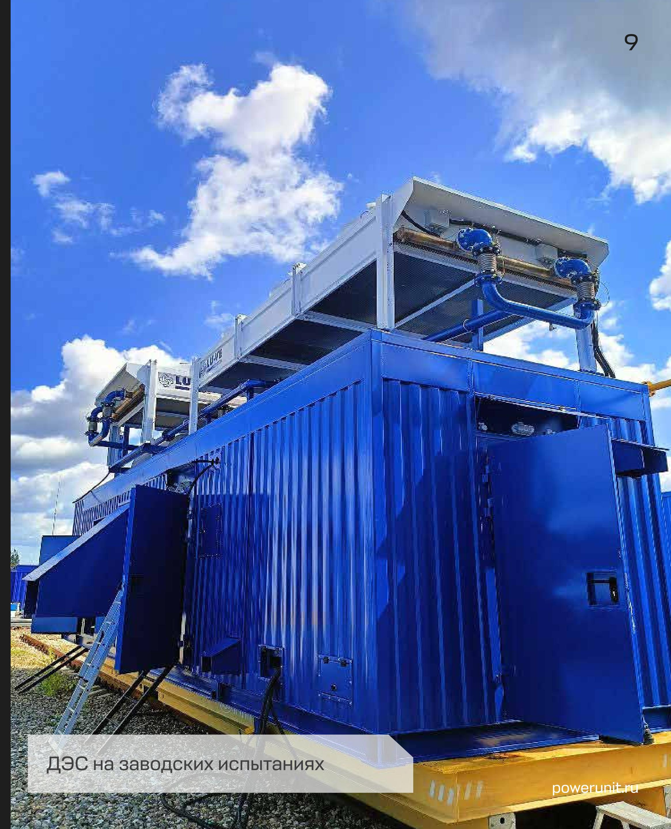
ДЭС на заводских испытаниях
