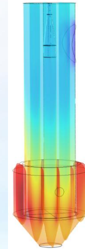
Скорость греющих газов во входном сечении w=0.1 м/с; температура греющих газов T_0=600^\circ\text{C}
