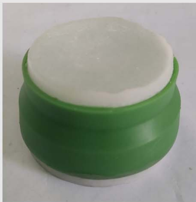
Напечатанная пресс-форма для изготовления карбамидного стержня отливки завихрителя
