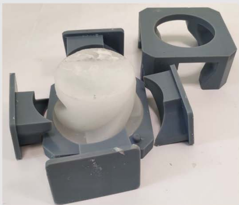
Напечатанная пресс-форма для изготовления карбамидного стержня отливки завихрителя
