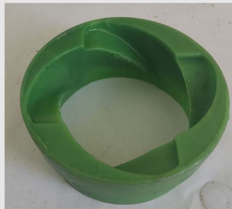
Напечатанная пресс-форма для изготовления карбамидного стержня отливки завихрителя
