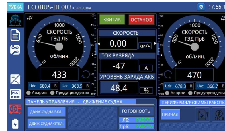
Главный экран системы мониторинга и сервиса (на примере единой электроэнергетической системы ООО «РЭО» – ЕЭЭС «Транит» для электросудов)
